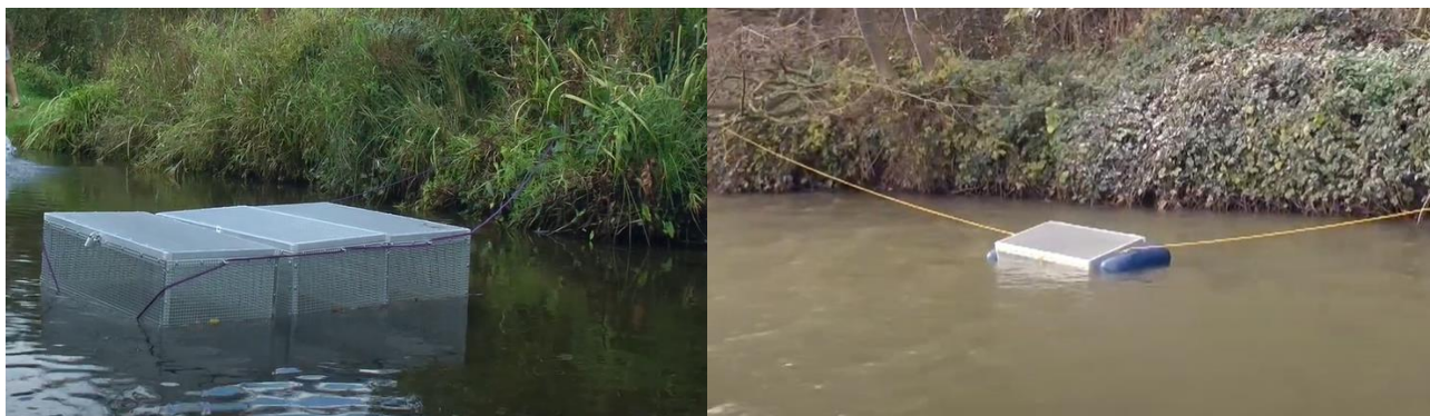
Figure 3: Placement des cages en fonction de la profondeur du cours d'eau. Les cages sont déposées sur le lit d'un cours d'eau peu profond ou positionnées en flottaison dans un cours d'eau profond.
