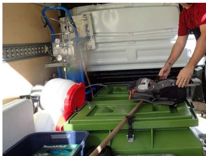
Figure 5 : Organisation du camion lors du transport des épinoches sur les sites d'études. En vert, les bacs de transport adaptés aux épinoches. Au fond à gauche, la bonbonne d'air comprimé reliée aux bulleurs se trouvant dans le fond des bacs
